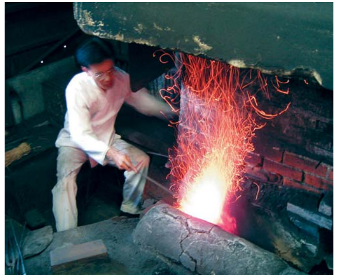
図4 玉鋼を炉で赤めている様子
