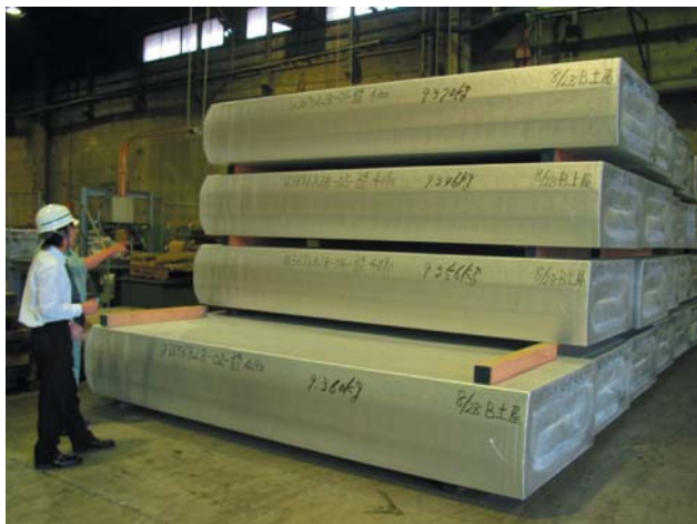
図5：積み上げられたスラブ
